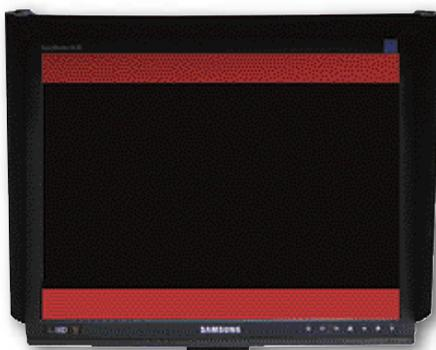
Abb. 93 Um die Helligkeitsunterschiede zu verdeutlichen, ist der Monitor in dieser Abbildung mit einem schwarzen Balken in der Mitte versehen. Deutlich ist zu erkennen, dass der Monitor unten heller ist als oben. Dieser Punkt ist sehr wichtig, wenn man die Farbbestimmung via Monitor und Digitalfotos durchführen möchte. (Dieses Phänomen lässt sich fotografisch nur schwer nachstellen. Daher wurden die Aufnahmen für den Druck so bearbeitet, dass der obere rote Teil dunkler wirkt als der untere)
