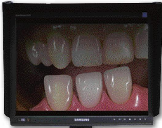
Abb. 95 Auf einem billigen Monitor mit nur einem, unten angebrachten Leuchtkörper wird das Foto wie in dieser Abbildung dargestellt. Das Foto ist oben dunkler als unten. Unsere Augen gleichen diesen Verlauf automatisch aus. Das heißt, der Unterschied wird nicht bewusst wahrgenommen, spiegelt sich aber in unserer Farbbestimmung wider
